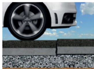
Ontstaan reflectiescheur door positieve schuifspanning
