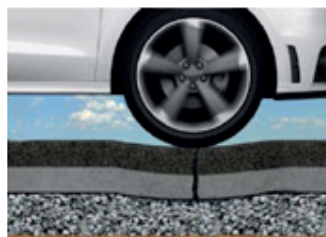
Ontstaan reflectiescheur door buiging
