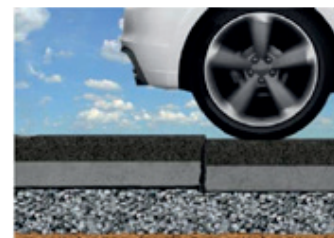
Ontstaan reflectiescheur door negatieve schuifspanning
