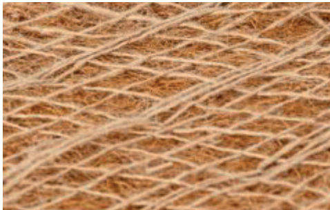
Kokos met jute net. Begroeien en beschermen tegen erosie van een helling met een kokosvezelmat, hellingshoek 10-30°.
